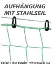
führung. Die Netze können bei Nichtgebrauch auf dem Stahlseil verschoben werden. Leichtes konstruktionsbedingtes Durchhängen der Stahlseile. Das abgebildete Netz besteht aus 2 mm Polypropylen und hat eine Maschenweite von 45 mm. Pro Meter Stahlseil sind je nach Maschenweite 3-6 Nylonösen oder Simplexhaken erforderlich.
