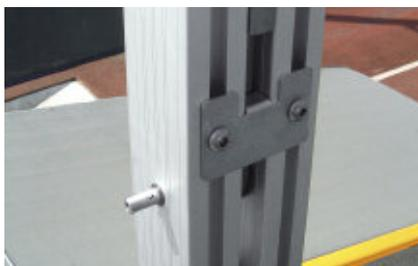
Antriebskurbeln sind abnehmbar. Unbefugten ist es somit nicht möglich die Anlage zu bedienen.
